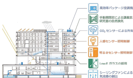
日射遮蔽の役割を果たす構造フレーム
