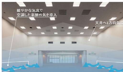
置換換気空調システムイメージ
