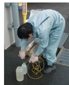
事業所排水の採水検査
