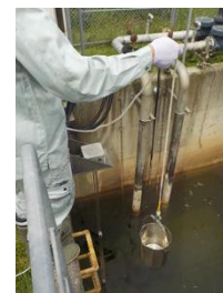
堺第7-3区環境調査 (浸出水の採取)
