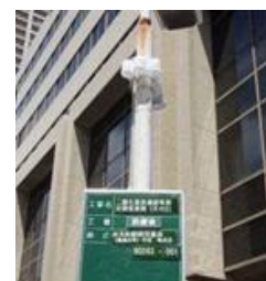
二酸化窒素濃度の簡易測定
