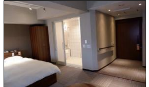
バリアフリー改修工事の例（2室を1室化改修したバリアフリールーム）
