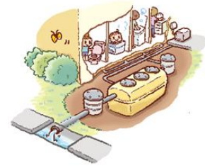
合併処理浄化槽設置イメージ
