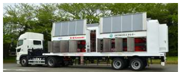
高圧水素トレーラー
