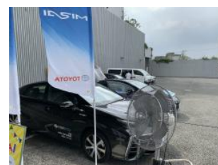
燃料電池自動車 (大型ミスト扇風機に給電中)
