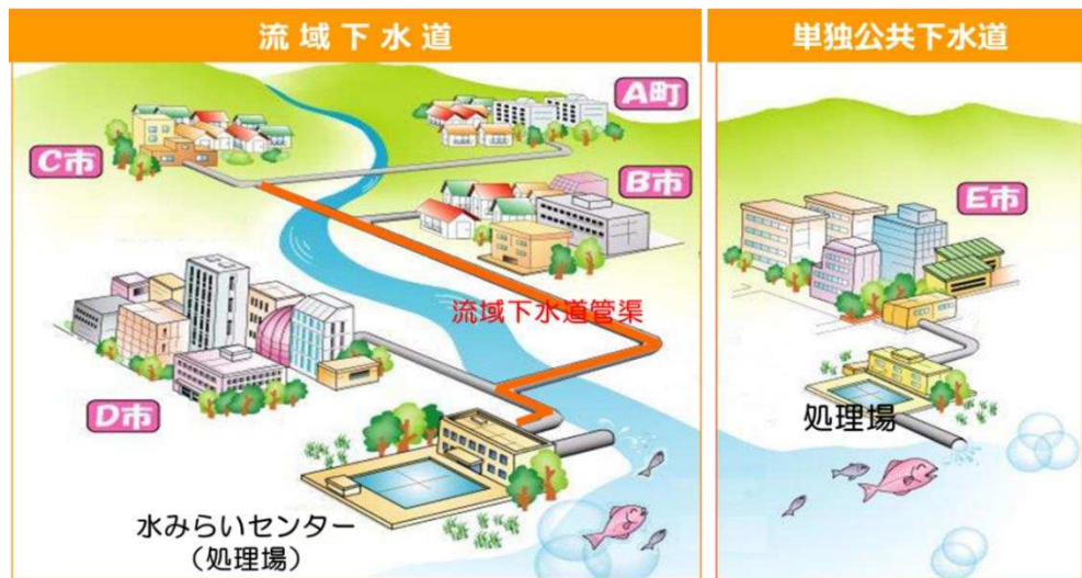
図 2.2-1 流域下水道と単独公共下水道の役割
