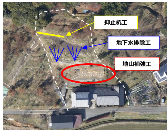
地すべり対策施設
