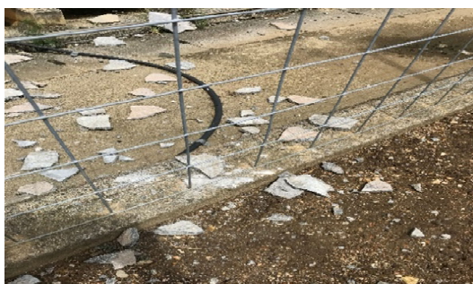
【事例 2】 校舎の屋上付近の外壁のモルタルの一部が落下。 落下片大きさ：30cm×120cm×2cm（約 25 キロ）
