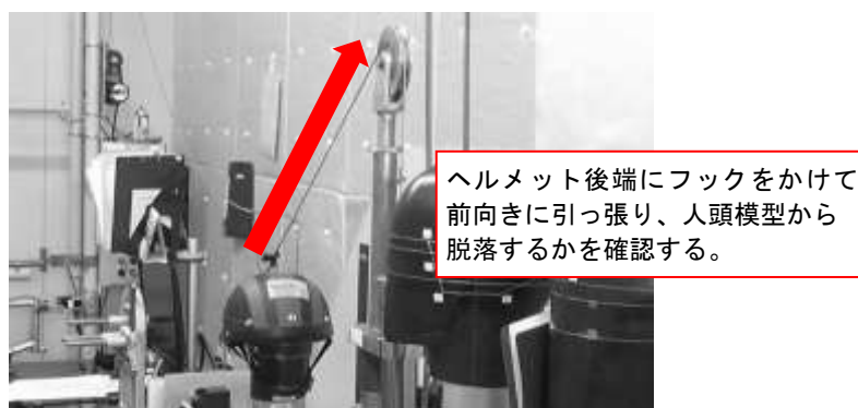
写真3. 保持装置の性能試験の様子
