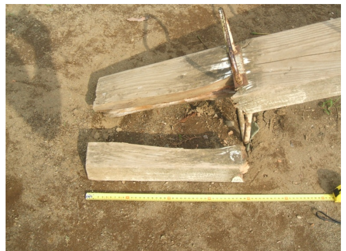
シーソー着座部破損状況
