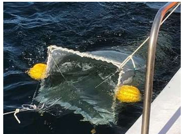
ニューストーンネットを設置した船で海中のマイクロプラスチック等を採取。
