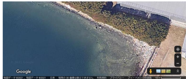
5 6 7 図Ⅱ-3-7 砂の堆積が見られる護岸の例
