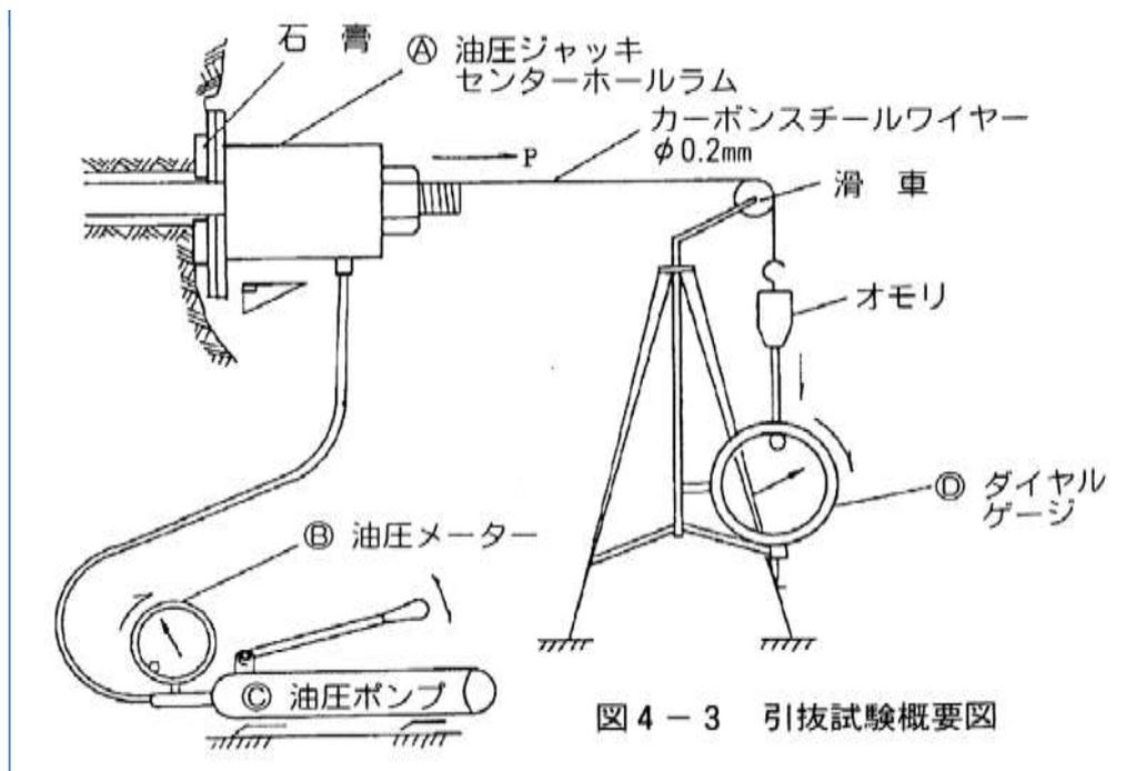
図 4 - 3 引抜試験概要図
