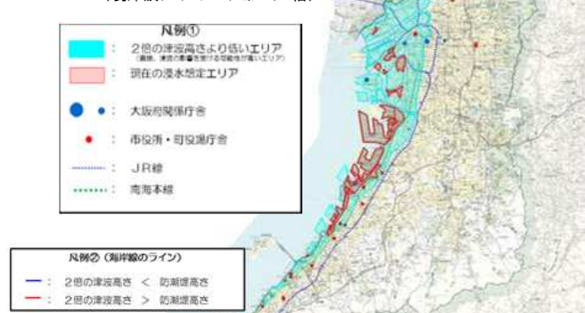
図表2 2倍の津波高による影響範囲 (現津波シミュレーションの2倍)
