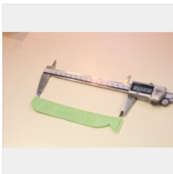
[写真] ノギスで寸法の正確さをチェック
