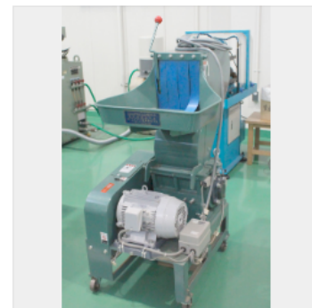
【写真】プラ製キャップを砕く粉砕機
