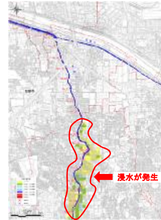
現況における時間雨量90ミリ程度の降雨による洪水リスク
