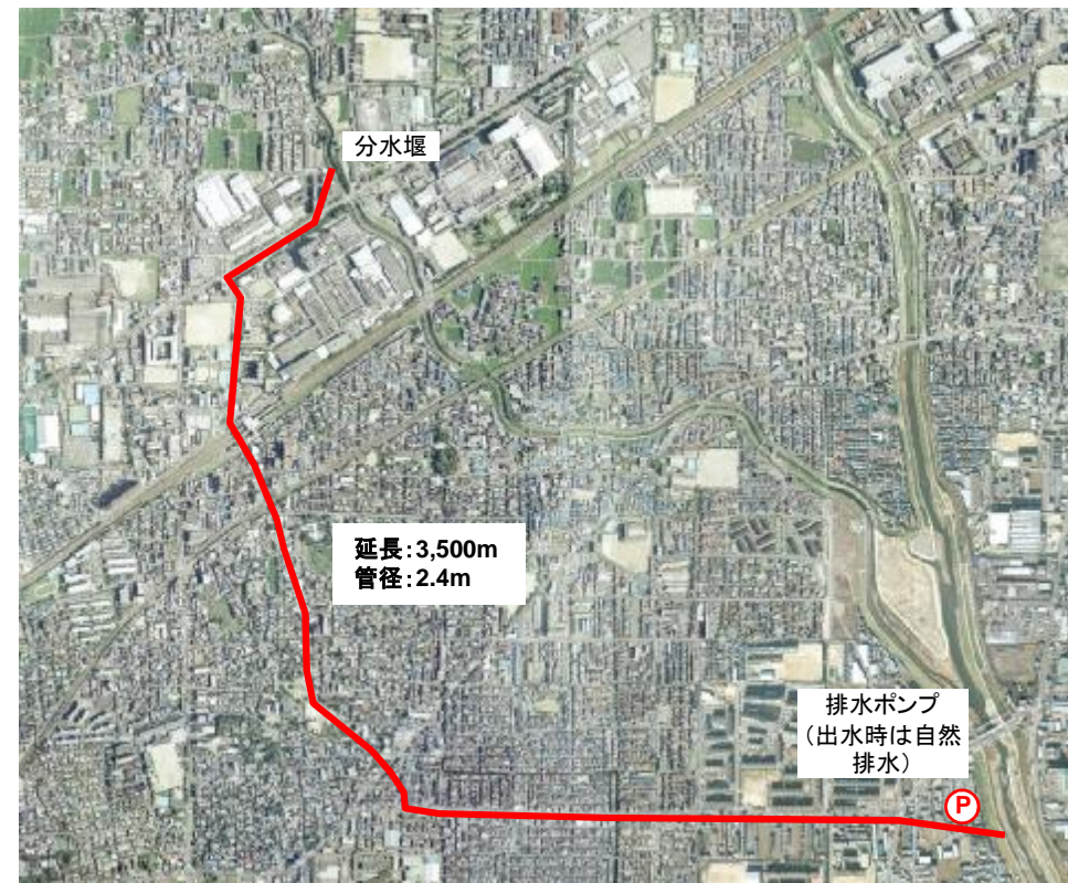
地下放水路ルート
