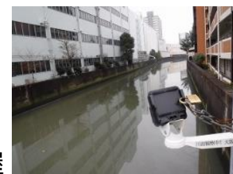
定点カメラによる スカム発生状況の監視
