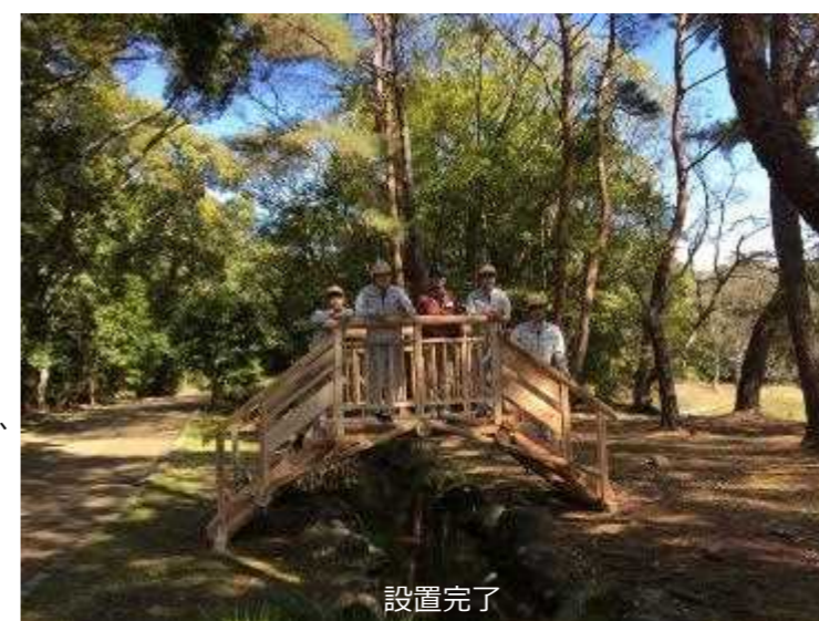
※ダ・ヴィンチの橋：接着剤や釘等を使用せず、摩擦、重力を利用したシンプルな構造の橋
