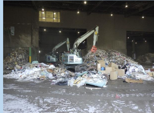
処理ラインへの投入前 重機による選別
