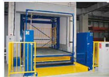
垂直搬送機設置
