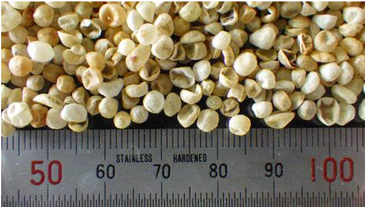
樹脂系被覆肥料被膜殻と推定される漂着した中空球状MP
