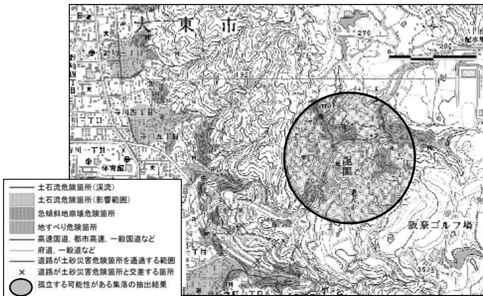
図 5.3 斜面災害によって集落への交通が寸断される可能性がある箇所の抽出
