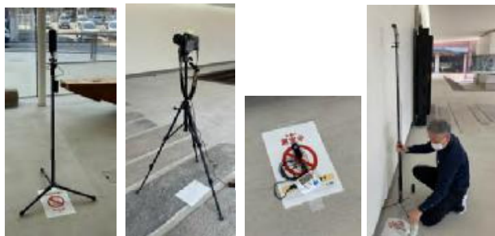
室内インターバルカメラ(左) 輝度撮影カメラ(右) 床面の照度計 鉛直照度の測定
