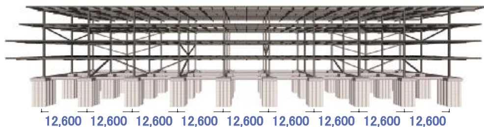
バランス良い合理的な天秤フレーム構造
