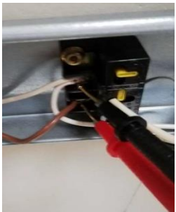
※テスターのピンプラグを端子台に接続して電圧測定
