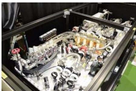
レーザー打音用小型高出力レーザー
