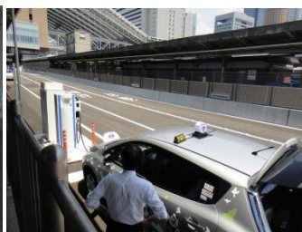
(写真 6) 充電中の EV タクシー待機レーンに入る前、15 分ほどで充電
