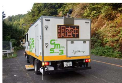
路面下空洞調査
