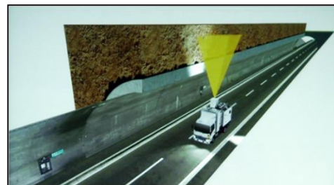
トンネル変位測定（H27～5年に1回全トンネル）
