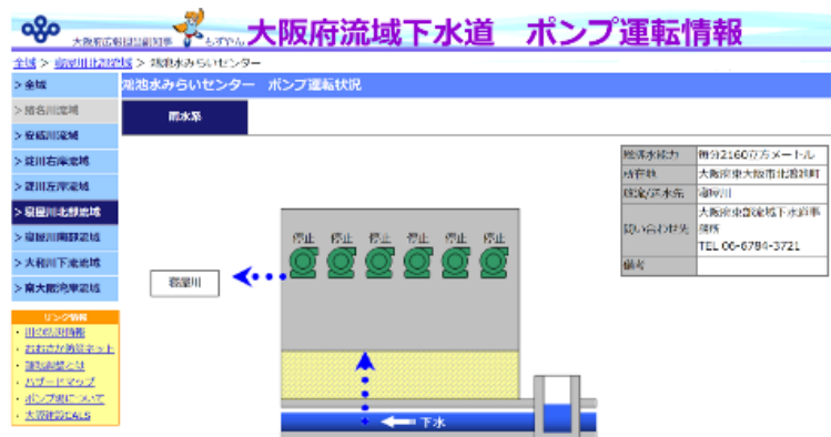
図 31 雨水ポンプ運転情報公開画面の例
