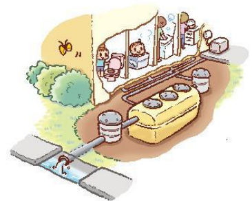
合併処理浄化槽設置イメージ
