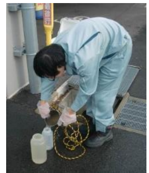
事業所排水の採水検査
