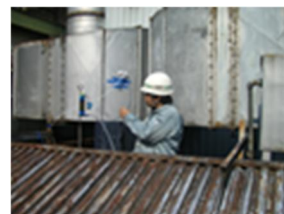
処理施設の排ガス採取
