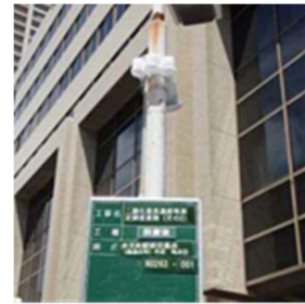
二酸化窒素濃度の簡易測定
