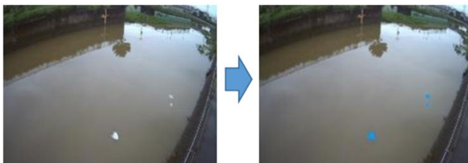
川を流下する人工物を AI がカウント（右写真：人工物を青色に着色）
