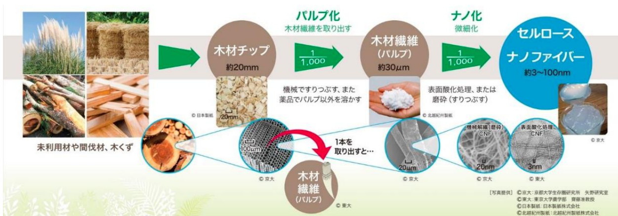
セルロースナノファイバー製造の概要図
