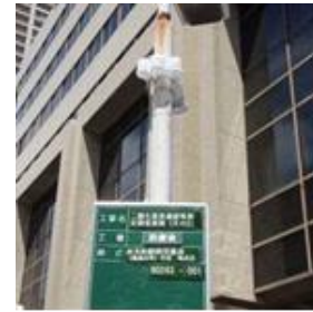
二酸化窒素濃度の簡易測定
