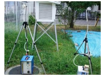
大気中の石綿濃度測定
