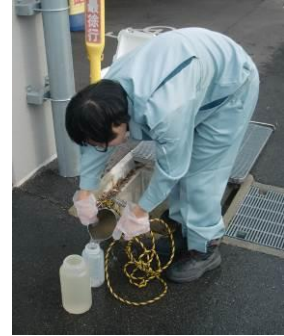
事業所排水の採水検査
