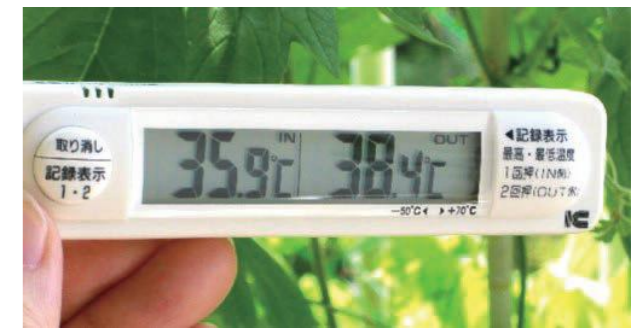
▲屋外が38.4°Cあっても、みどりのカーテンがある屋内は、35.9°C ※本体(IN)と外部センサー(OUT)で2か所同時に測定できる温度計で測定
