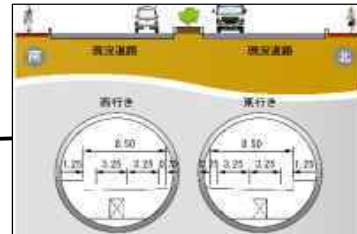
標準断面図（シールドトンネル部） 【淀川左岸線延伸部】
