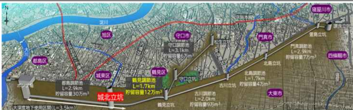
寝屋川北部地下河川断面イメージ
