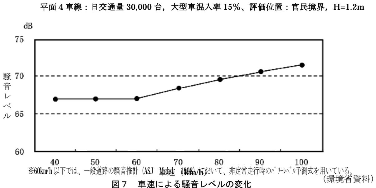
図7 車速による騒音レベルの変化
