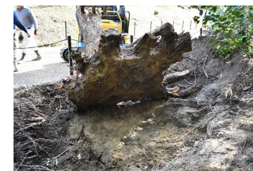
根系掘り取り状況 根は0.5mより浅い範囲に集中している。
