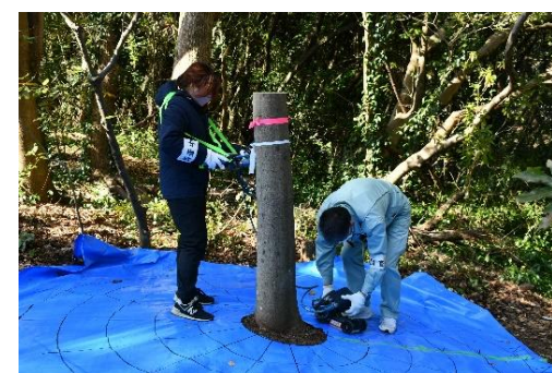
地中レーダー探査状況 同心円に沿ってアンテナを移動させ、測定
