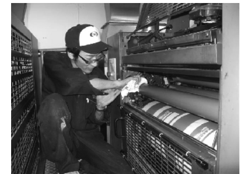
図2 ローラ交換作業
