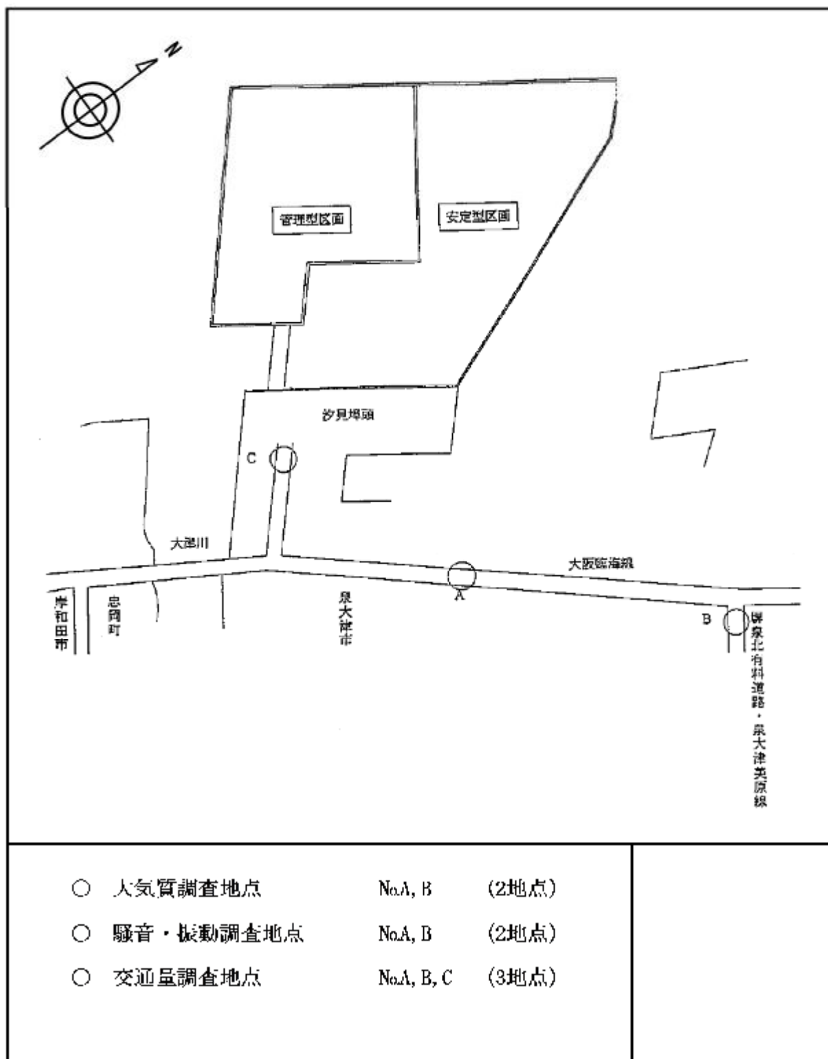
図-1(4) 廃棄物搬入施設周辺における調査地点(泉大津基地)
